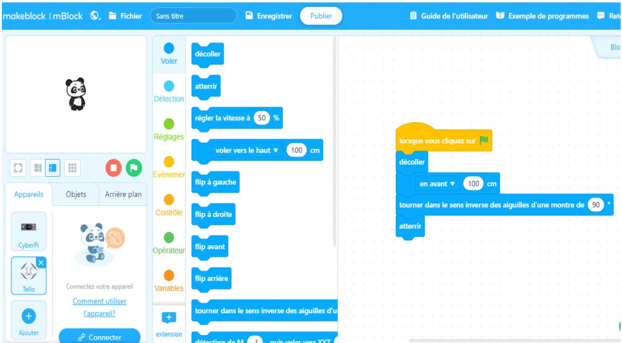
Possibilité d'installer la **version PC ou MAC** ou d'utiliser la **version en ligne** qui nécessite l'installation du driver mLink permettant de connecter les périphériques détectables par mBlock 5
